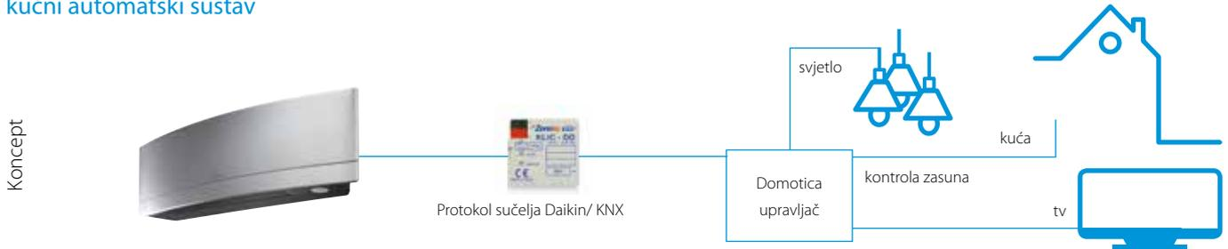
Priključite Sky Air / VRV unutarnje jedinice na KNX sučelje za BMS integraciju
